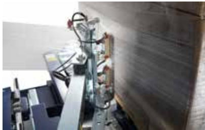
Sistema automatico di pinza, taglio e spalmatura film (o saldatura opt.) Automatic film clamping, cutting and spreading (or welding opt.) system
