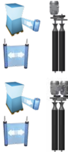
Top (opt.) Mettifoglio automatico per la protezione totale del prodotto dall'acqua Automatic top sheet insertion for the total product protection from water
