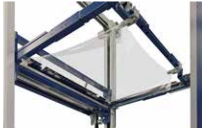
Top (opt.) Mettifoglio automatico per la protezione totale del prodotto dall'acqua Automatic top sheet insertion for the total product protection from water
